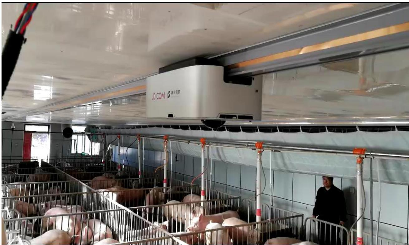
智能巡检机器人是为生产保驾护航的永动机。它改变了常规的技术员每天早晨巡检一次，凭借养殖经验，下发生产任务的传统生产模式，通过神农大脑实时分析猪场里面的视频、声音，发现问题，生成解决方案，下达给相应的工作人员。巡检机器人具备点数，估重，猪只体温，室温检测，声音检测，疫病分析，室内湿度，有毒气体等监控等功能。
